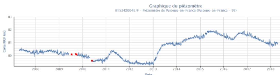
Figure 18 : Suivi piézométrique de la nappe du Lutétien-Cuisien ouvrage 01534X0049 (2007 – 2018) (G2H Conseils, 2019)
